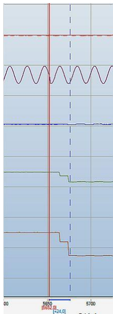
Messstrom- Sprung von 1 A auf 0,5 A
